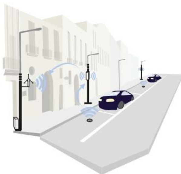
Obrázek 12 Schéma přenosu informací ze senzoru (zdroj: smart4city.spel.cz)
